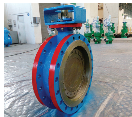
После нанесения покрытия
